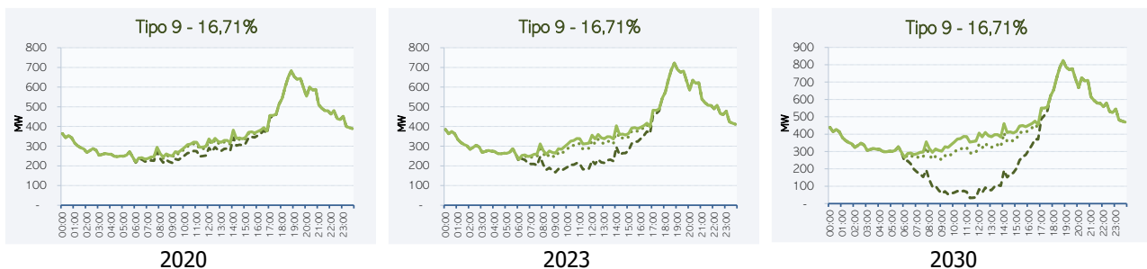
Figura 4: Tipo 9 dos Transformadores MT/BT da CEMIG D com inserção de Micro GD Local
