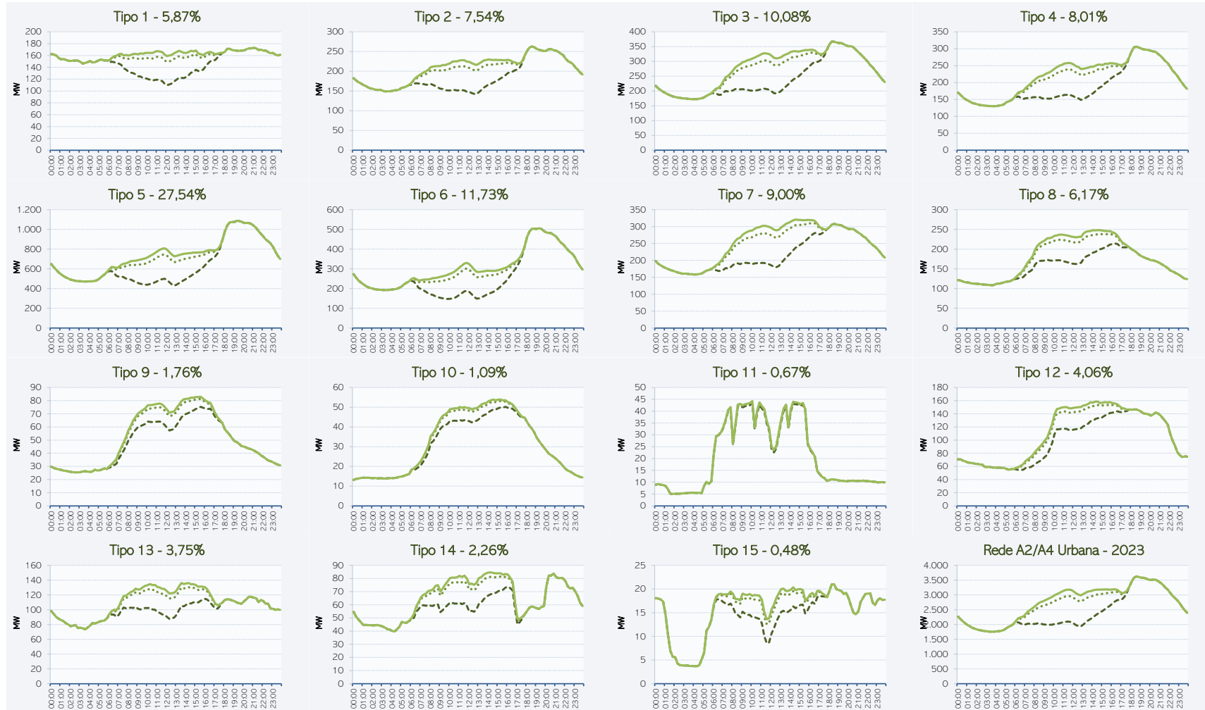
Figura 32: Efeito da Inserção de Micro GFV Local com tarifação proposta nas redes Urbanas de Média Tensão da CEMIG-D em 2023
