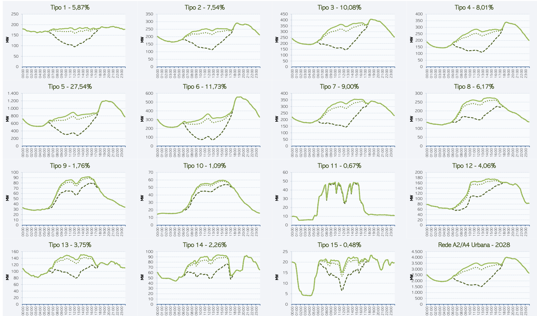
Figura 37: Efeito da Inserção de Micro GFV Local com tarifação proposta nas redes Urbanas de Média Tensão da CEMIG-D em 2028
