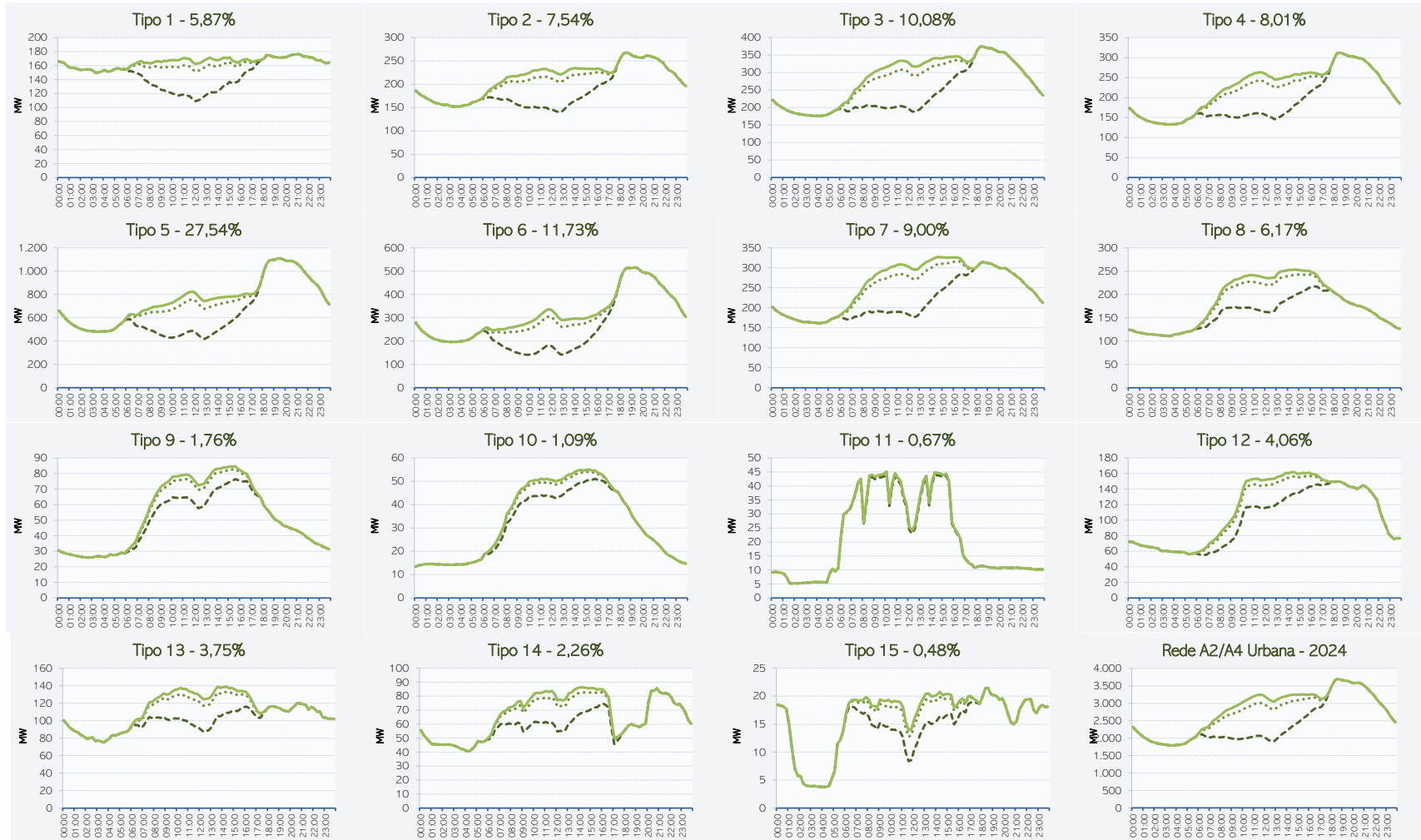
Figura 33: Efeito da Inserção de Micro GFV Local com tarifação proposta nas redes Urbanas de Média Tensão da CEMIG-D em 2024
